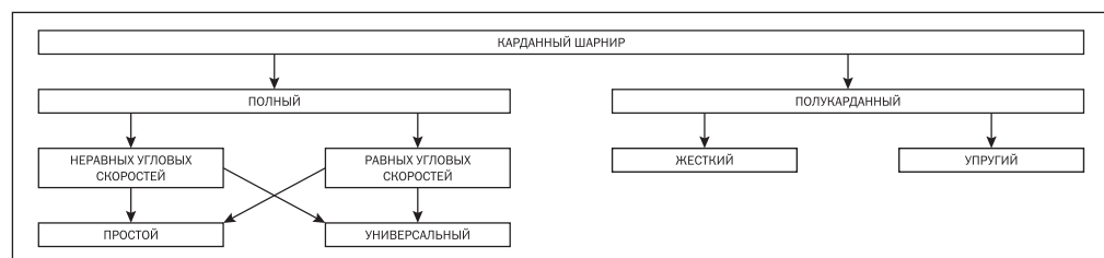
Рис. 3.17. Классификация карданных шарниров
