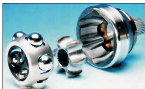
Рис. 3.24. Шестишариковый шарнир с делительными канавками
