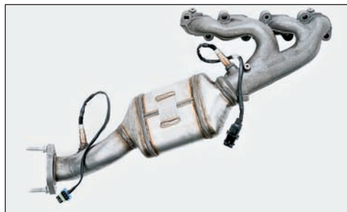
Рис. 2.78. Выпускной коллектор двигателя с предварительным нейтрализатором
