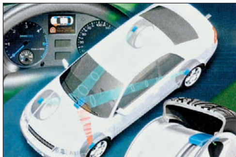
Рис. 4.19. Система производства компании Siemens постоянно контролирует давление воздуха в шинах посредством датчиков, установленных в колесах
