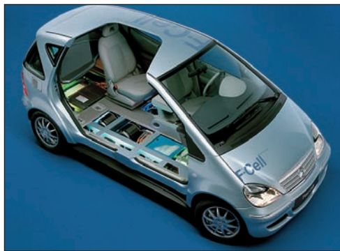
Рис. 8.12. Автомобиль на топливных элементах производства DaimlerChrysler изготовлен на базе Mercedes A-класса, использует силовую установку, расположенную под полом автомобиля
