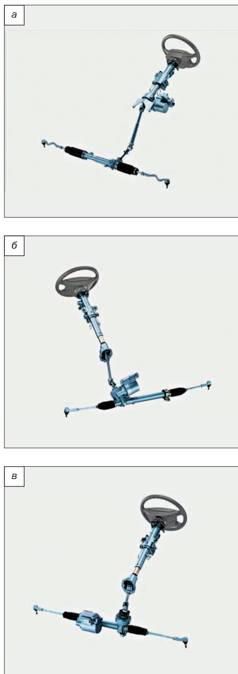
Рис. 5.14. Электрические усилители рулевого управления: а — с воздействием на рулевой вал; б — с воздействием на шестерню рулевого механизма; в — с воздействием на рейку рулевого механизма
