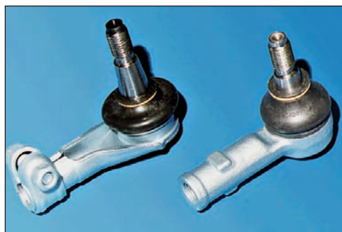
Рис. 5.9. Шарнир рулевого привода с шаровым пальцем
