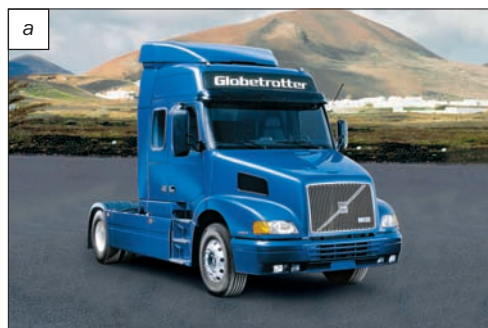
Рис. 7.9. Типы кабин: а — капотный; б — бескапотный
